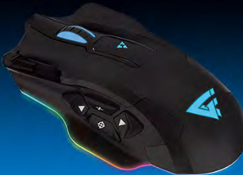
**Onboard Memory.** Microcontrolador de 8 bits y memoria integrada de 128kb. Guarda la configuración de hasta 5 perfiles y lleva tus macros contigo.
